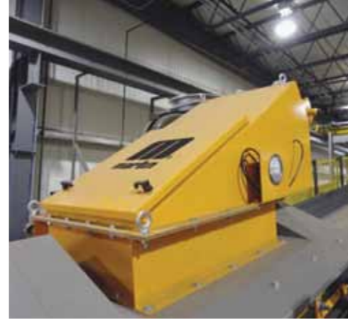
Şekil 5: Entegre hava temizleme sistemi Figure 5: Integrated air cleaner system
