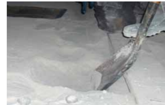
Şekil 7: Ani duruş sonrası değirmen içerisinde yetersiz havalandırmaya bağlı olarak biriken malzeme
